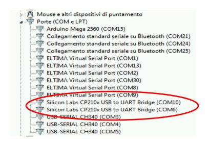
In questo caso abbiamo due porte COM poiché al PC sono collegati un IC7300 (COM10) e un IC7600 (COM6)
