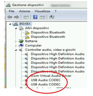
In questo caso abbiamo due USB Audio CODEC poiché al PC sono collegati un IC7300 e un IC7600
