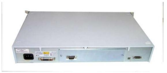
Primo passo svuotare il contenitore dello switch per far spazio all'alimentatore 12V 30A per strisce led acquistato on line
